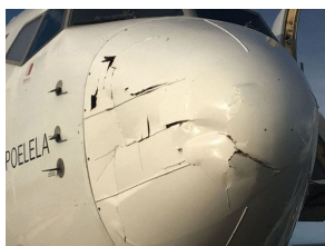
Obrázok 1. Poškodený Boeing 737 po zrážke s dronom [4] a náraz dronu do krídla [4]
