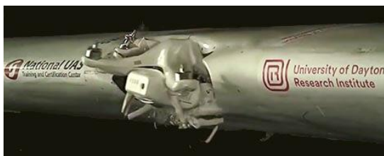
Obrázok 1. Poškodený Boeing 737 po zrážke s dronom [4] a náraz dronu do krídla [4]
